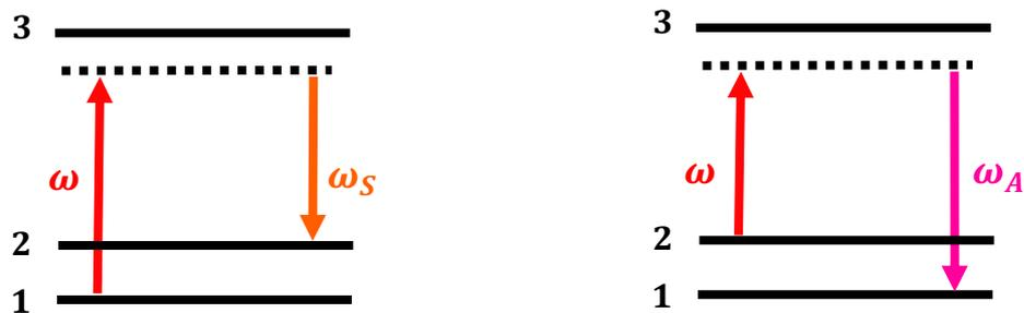
Figure 3.8 : Diagramme des niveaux d'énergie qui illustre la diffusion Raman Stokes et anti-Stokes.
