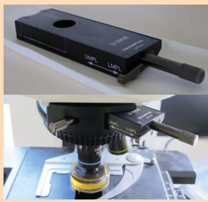
Figure 4. Photographies d'un CID Nomarski commercial (modèle pour épiscopie). (a) Le composant dans son boîtier d'utilisation. (b) Le composant en position dans la tête du microscope juste au-dessus de la tourelle porte-objectifs. Le prisme de Nomarski, qui se présente en pratique comme une simple lame à faces parallèles de forme circulaire, n'est pas directement visible sur les photographies. Il est positionné en contre-bas de l'ouverture circulaire visible sur la photographie (a). La grande molette sur la droite permet le réglage du paramètre \varphi_0 .
