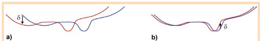
Figure 1. Représentation schématique de l'interférométrie à décalage latéral. (a) Fronts d'onde dédoublés pour un large décalage. (b) Fronts d'onde dédoublés pour un petit décalage. L'écart local d'altitude \delta entre les deux surfaces est proportionnel à la pente locale (au gradient) du front d'onde dans la direction du dédoublement. La différence de marche \delta entre les deux fronts d'onde donne un déphasage local de \Delta\varphi = 2\pi\delta/\lambda . \delta et \Delta\varphi sont des grandeurs algébriques. Dans le cas (b) le signe de \Delta\varphi dépend donc du signe du gradient.
