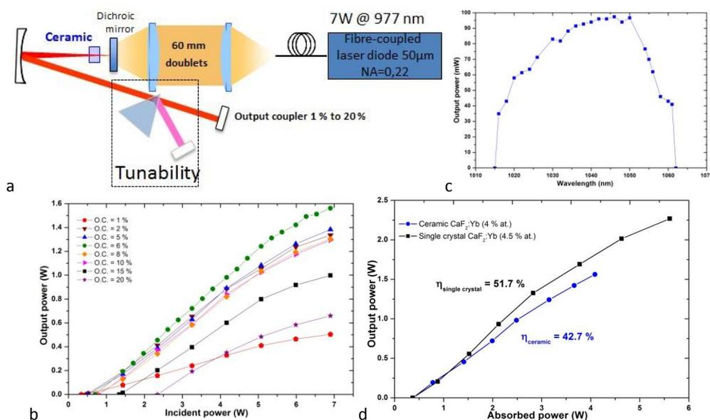
**Fig. 1:** Résultat laser d'une céramique Yb:CaF<sub>2</sub> : dispositif expérimental, puissance de sortie en fonction du coupleur, accordabilité et comparaison avec un monocristal.
