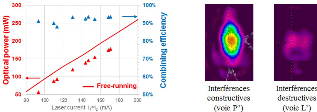
Fig. 2 : (gauche) Puissance optique combinée en face avant voie P' (triangles rouges) et efficacité de combinaison correspondante (triangles bleus) en fonction du courant d'alimentation des deux lasers *ridges*. La courbe rouge correspond à la somme des puissances optiques extraites de chaque laser indépendamment. (droite) Profil de faisceau combiné et de la voie de perte pour les émetteurs à section évasée.
